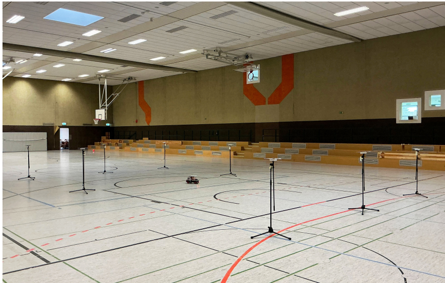
Abbildung 5.1: Versuchsaufbau des UWB-Positionierungssystems in einer Dreifeldsporthalle. Insgesamt acht UWB-Anker wurden auf Stativen rund um das Spielfeld platziert und jeweils mit einem ArUco-Marker versehen. Eine an der Hallendecke montierte Kamera erfasst die Marker und stellt darauf basierende Ground Truth Messungen bereit.
