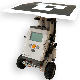
Abbildung 5.2: LEGO® MINDSTORMS® Roboter mit UWB-Tag und ArUco-Marker. Mithilfe des Roboters können vorab programmierte Testpfade unter vergleichbaren Bedingungen wiederholt werden.
