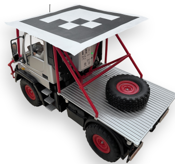
Abbildung 5.3: Ferngesteuertes Modellauto mit UWB-Tag und ArUco-Marker. Das Auto lässt sich beliebig durch das Testgebiet steuern und eignet sich so für flexible Testszenarien.
