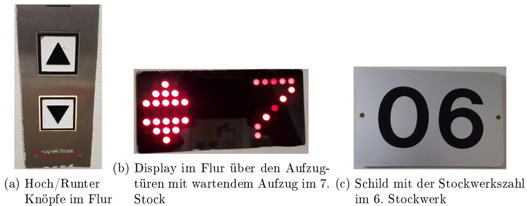
Abbildung 3.2: Die drei Arten der Informationen, auf die der Roboter reagieren soll. Die Knöpfe zum Rufen des Aufzugs in a), die Anzeige, in welchem Stockwerk sich der Aufzug befindet in b) und das Schild im Flur mit dem aktuellen Stockwerk in c)
