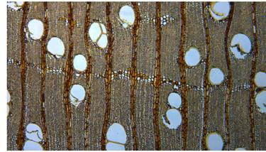
Abbildung 4: *Entandrophragma utile* (Sipo), mikroskopischer Querschnitt
