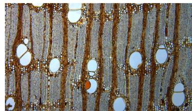
Abbildung 2: *Entandrophragma candollei* (Kosipo), mikroskopischer Querschnitt
