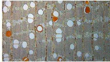
Abbildung 3: *Entandrophragma cylindricum* (Sapeli), mikroskopischer Querschnitt
