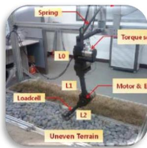
Abb. 2.4: Versuchsaufbau – Propriozeption eines Beins. [Kim10]
