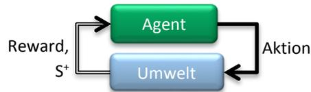
Abb. 2.6: Basiskomponentenmodell des Reinforcement-Learning
