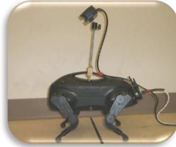
**Abb. 2.1: LittleDog robot ausgestattet mit Tyzx DeepSea Stereo Kamera [Kol09].**
