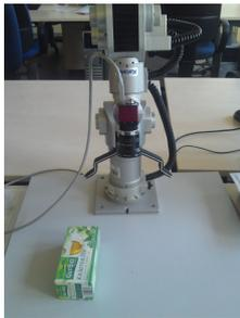
(a) Startpose angefahren + Zielpose berechnen
