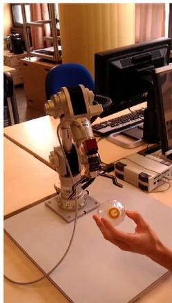
(a) Objektpose + Zielpose berechnen
