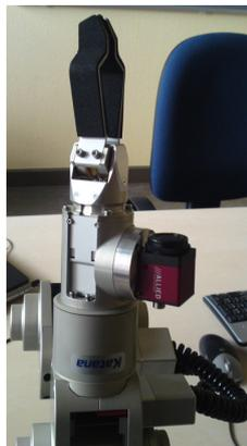
**Abbildung 4.11:** Am Katana-Greifarm befestigte FireWire-Kamera.
