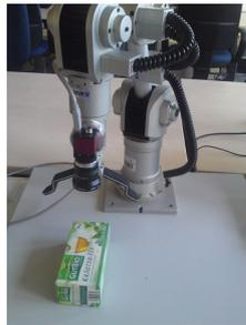
(b) Zielpose angefahren + Greifpose berechnen
