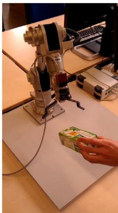
(f) Objektpose + Zielpose berechnen
