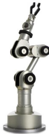
**Abbildung 4.5:** Katana-Greifarm mit fünf Gelenken und einem Zwei-Finger-Greifer. [NEU10]
