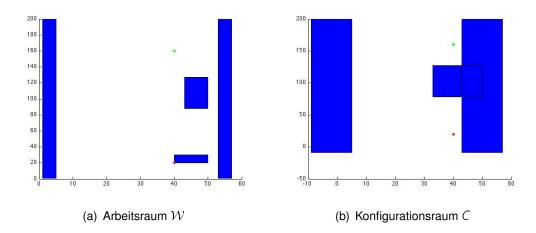
Abbildung 2.18: Transformation von Hindernissen in den Konfigurationsraum
