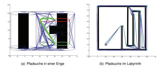
Abbildung 2.21: Pfadsuche für ein nicht holonomes Fahrzeug mittels Dubins Kurven. In schwarz sind die Hindernisse, in blau alle möglichen Pfade und grün der gefundene Pfad dargestellt. Die roten bzw. grünen Kreise sind für der Startbzw. Zielkonfiguration hinzugefügt.
