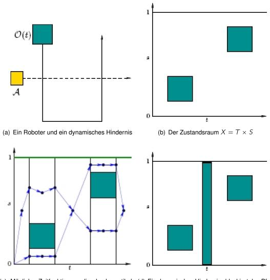
(c) Mögliche Zeitfunktionen, die durch vertikale (d) Ein dynamisches Hinderniss blockiert den Pfad Zerlegung entstehen au
