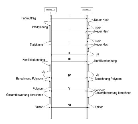
Abbildung 3.7: Das Protokoll als Sequenzdiagramm. Die Nachrichten I wurden für die Übersichtlichkeit nach 3 Übertragnungen entfernt.
