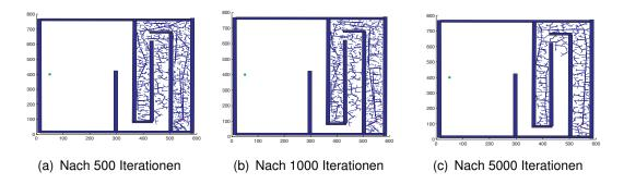
Abbildung 2.20: Versuche mit dem RRT- Ansatz in engen Umgebungen. Nach n Iterationen ist das Ziel nicht erreicht.
