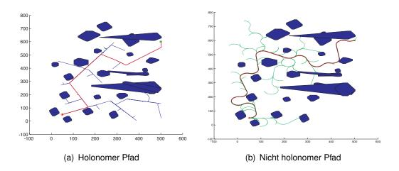
Abbildung 2.26: Der holonome RRT und der nicht holonome RRT im Vergleich. Der holonome RRT konnte nach 59 Iterationen einen Pfad finden. Der nicht holonome Pfad wurde nach 635 Iterationen gefunden.
