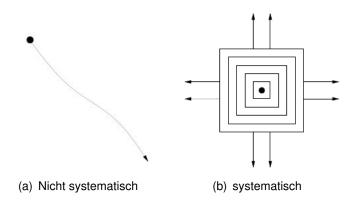
Abbildung 2.2: Systematik von Suchalgorithmen (aus [LaValle (2006),S 32])
