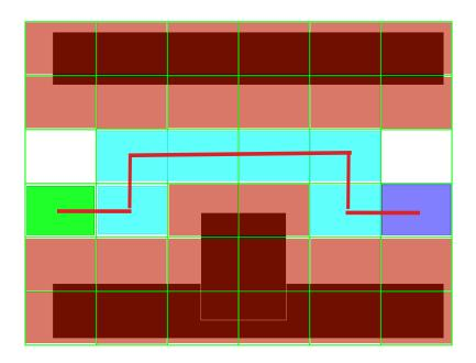
Abbildung 2.17: Pfadsuche für ein holonomes Fahrzeug mittels dem Gitterbasierten Ansatz. In Hindernisse (schwarz) sind um die Abmessungen des Fahrzeuges vergrößert. Die belegten Zellen sind rot markiert. Die von der Suche besuchten hellblau. Der Startpunkt ist grün und das Ziel blau markiert. In rot ist zudem der gefundene Pfad eingezeichnet.
