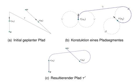
Abbildung 2.16: Entkoppelter Ansatz für die Planung mit Zwangsbedingungen (aus [LaValle (2006), S.844f])
