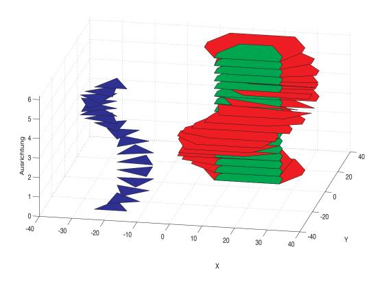
Abbildung 2.9: Ein Fahrzeug (blau), ein Hindernis (grün) und der Hindernisraum  $C_{obs}$  (blau) für die Fahrzeugausrichtungen  $\theta \in [0, 2\pi]$ .
