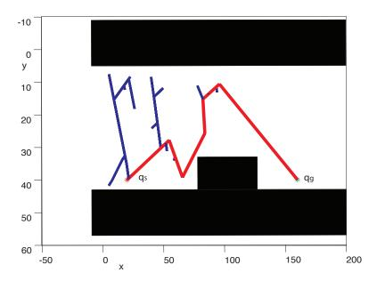
Abbildung 2.19: Pfadsuche für ein holonomes Fahrzeug mittels dem RRT Ansatz. In schwarz sind die Hindernisse, in blau die Pfade zu den zufälligen Konfigurationen und rot der gefundene Pfad dargestellt.
