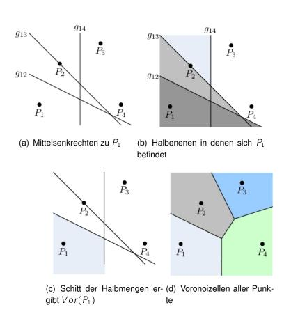
Abbildung 2.11: Erstellung des Vornoi- Diagramms (aus [Schubert (2006), S.35])
