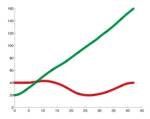
Abbildung 3.1: Der Verlauf der X- (rot) und Y- (grün) Koordinate über die Zeit. Der schwarze Strich ist die Approximation mit Splines, die Kreise sind die übertragenen Konfigurationen
