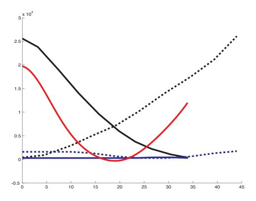
Abbildung 3.3: Berechnung der Konfliktzeitpunkte. In schwarz sind die Verläufe der X-, in blau der Y- Koordinaten zweier Fahrzeuge dargestellt. Der rote Graph ist der Verlauf von  $\Delta S_x(t)^2 + \Delta S_y(t)^2 - (r^i + r^j)^2$ . Nullstellen dieses Graphen sind die Begrenzungen von Konfliktintervallen.
