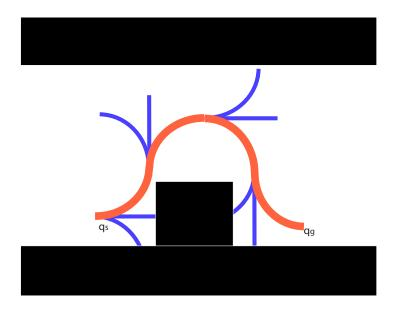
Abbildung 2.23: Pfadsuche für ein nicht holonomes Fahrzeug mittels dem *Sampling Based*Ansatz. In schwarz sind die Hindernisse, in blau untersuchte Teilpfade und in rot der gefundene Pfad dargestellt.
