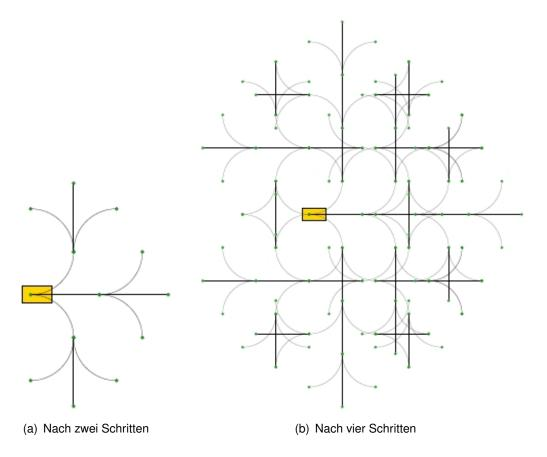
Abbildung 2.22: Erreichbarkeitsgraph des Dubins Fahrzeuges (aus [LaValle (2006), S. 804])
