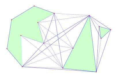
Abbildung 2.12: Sichtbarkeitsgraph. Die durch die Reduzierung entfallenden Kanten sind unterbrochen dargestellt.
