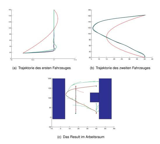
Abbildung 3.2: Interpolation zweier Trajektorien (schwarz) durch Spilnes mit 3(rot), 10(grün) und 15(blau) Stützstellen
