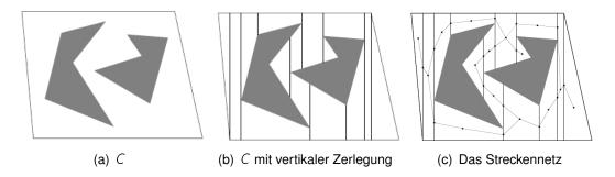
Abbildung 2.10: Zerlegung von  $C_{free}$  durch die vertikale Zellzerlegung (aus [LaValle (2006), S.255f])
